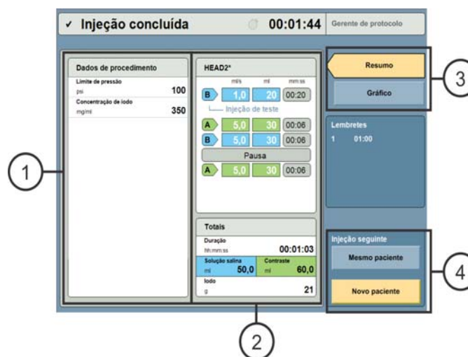
Figura 11 - 1: Injeção concluída – Resumo
