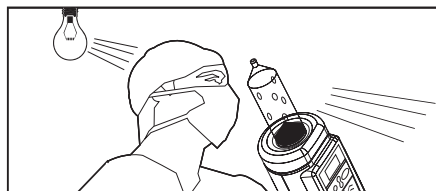
Figura 9 - 4: FluiDots iluminados adequadamente
